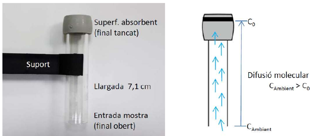
Figura 1: Principi de funcionament dels tub passius de difusió de NO 2 de tipus Palmes, on C Ambient és la concentració de la mostra ambient i C 0 és la concentració a la superfície de l'absorbent.
